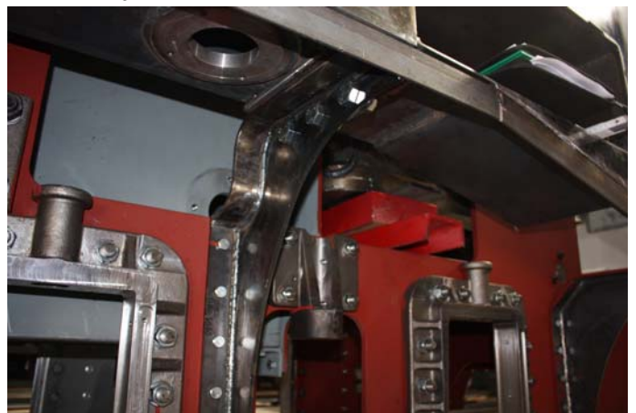
Eingeschränkte Platzverhältnisse zwischen dem Rahmen mit den Rahmenwasserkästen und den äußeren Wasserkästen.
