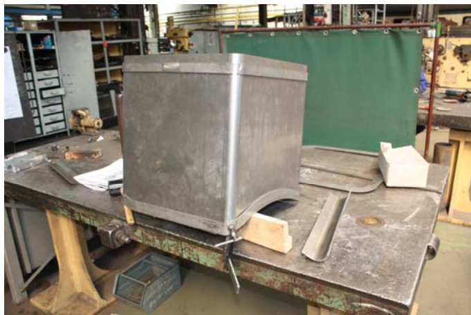
Die Endbearbeitung des Sandkastens und der Bedienmechanik im Kasten wurde begonnen.
