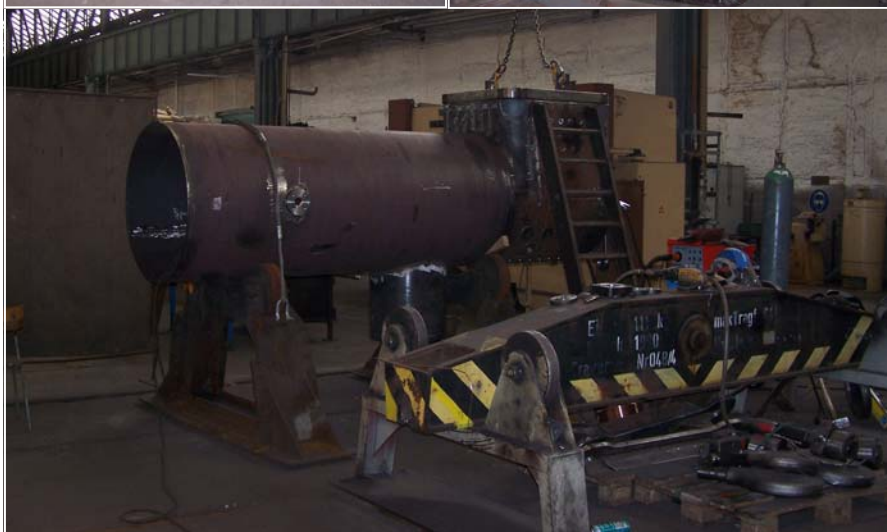
oben: letzte Innenarbeiten am Langkessel Mitte: Feuerbüchse gefertigt und bereit zum Einpassen unten: Langkessel mit eingefügter Feuerbüchse
