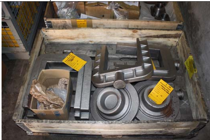
Gussteile: Achslagerführungen und Zylinderdeckel (Olbersdorfer Guss)
