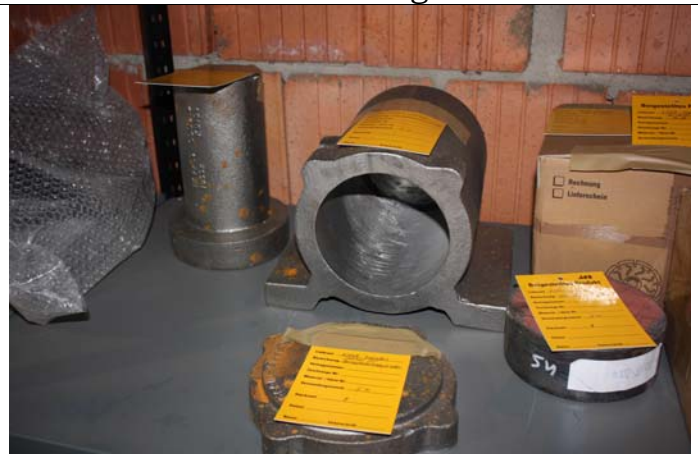
Gussteile Dampfbremse: Kolben, Gehäuse, Deckel (Gießerei Kessler, Leipzig)
