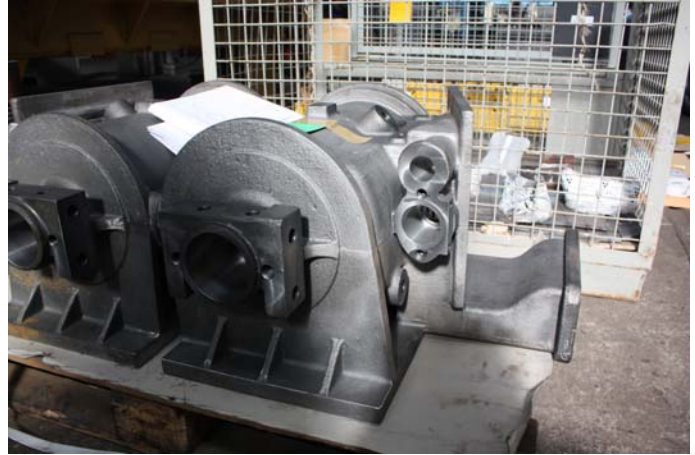
Dampfzylinder nach mechanischer Bearbeitung
