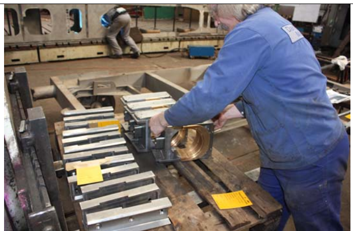
Achslagerführungen und Achslagergehäuse einbaufertig angeliefert
