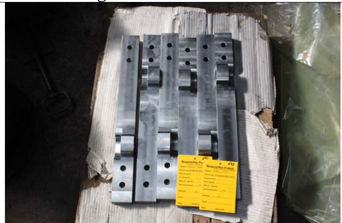
Achsgabelsteg einbaufertig angeliefert
