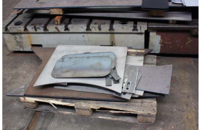
Angelieferte Blechteile für seitliche Wasserkästen und Werkzeugkasten
