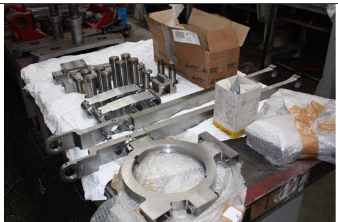
Schieberschubstange, weitere Steuerungsteile
