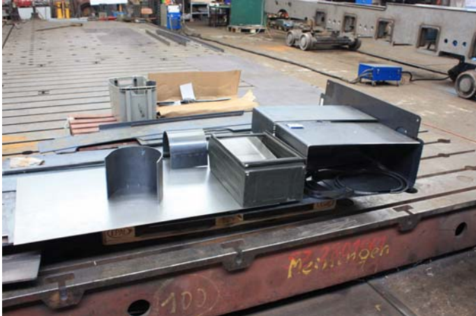
Angelieferte Blechteile für seitliche Wasserkästen und Werkzeugkasten
