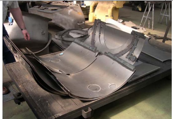
Kesselverkleidungsbleche fertig bearbeitet
