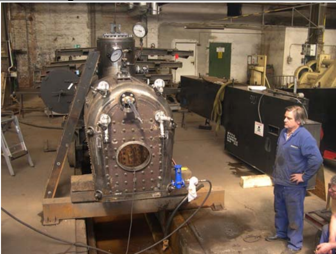
Links: Vorbereitung auf Warmdruckprobe des Kessels. Re.: Kesseldruckprobe mit Prüfung der Schweißausführung und Dichtheit durch TÜV Thüringen.
