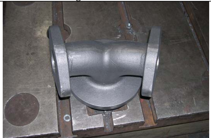
Anlieferung Einströmzweigrohr (Modellbau Chemnitz GmbH / Eisenwerk GmbH Elterlein)
