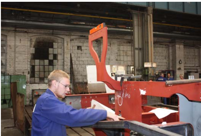
Anbau des Steuerbockträgers an den Rahmen und Einbringen des Lochs für das Abschlammentventil.
