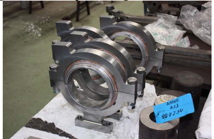
Exzenter scheiben mit Rotgusslagerhalbringen und unbearbeitetem Weißmetallausguss
