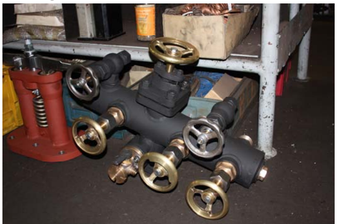
Das Gruppenventil ist fertig gestellt und wartet auf den Anbau an der Lok.
