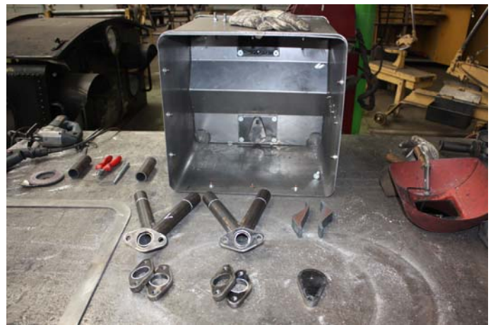
Die Sandstreumechnik im Sandkasten wird angefertigt und am Kasten schrittweise vervollständigt.
