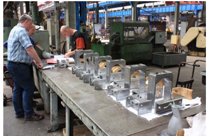
Die Achslager werden für das Einbringen des Weißmetallausguss vorbereitet und die Montage Teile zusammengestellt.
