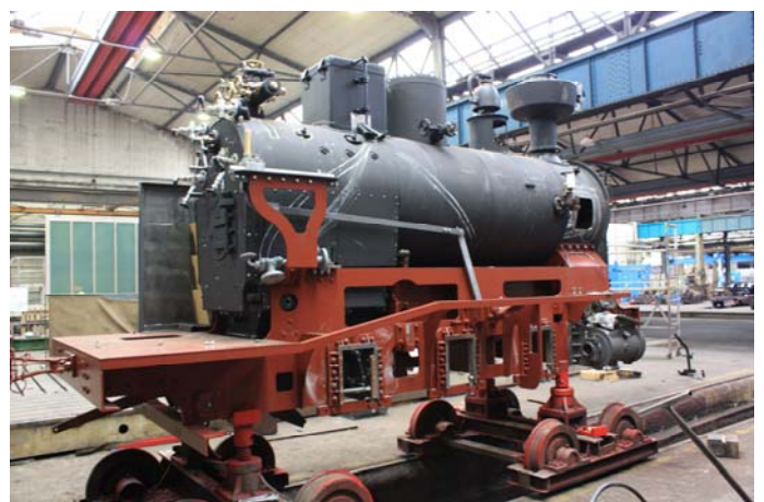
In den nächsten Tagen soll nun das Anpassen der Rohrleitungen (Sandfallrohre, Saugluft, Wasserkastenverbindung, Wasserkastenentlüftung und Speisewasserleitung) im Bereich der seitlichen Wasserkästen erfolgen.
