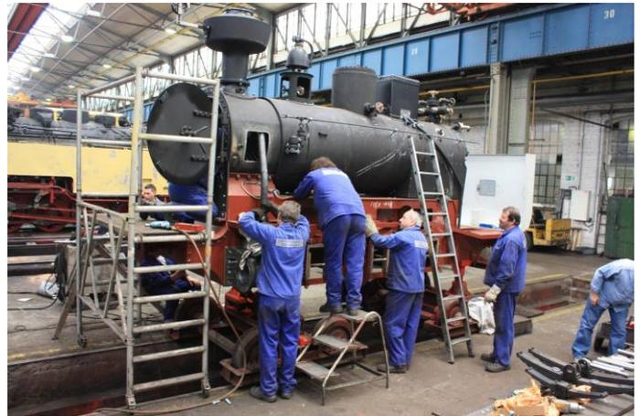
Anpassen des linken Einströmrohres zwischen Rauchkammer und Zylinder.
