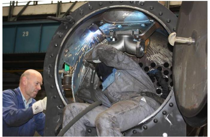
Die Träger des Ausströmzweigrohres werden an der Rauchkammerwand angeschweißt.
