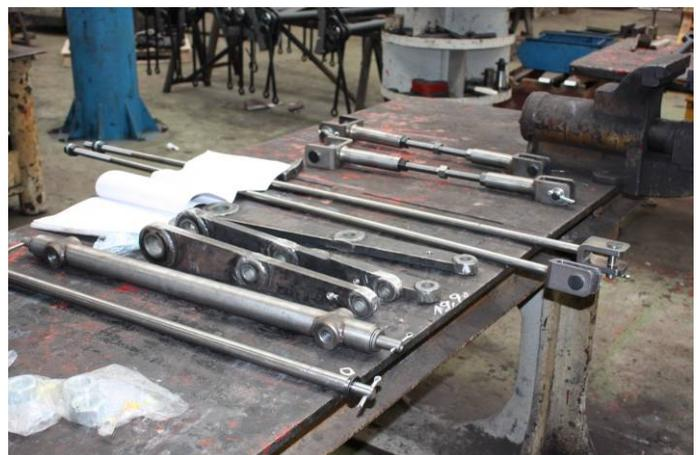
Die Komponenten der mechanischen Bremse werden für den Einbau vorbereitet.
