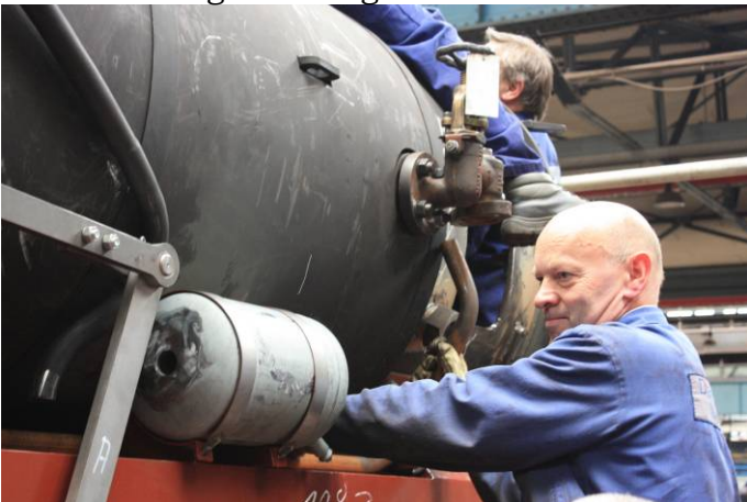
Die rechte Speiswasserleitung muss zwischen Rahmen, Kessel und Steuerungsstange eingepasst werden.
