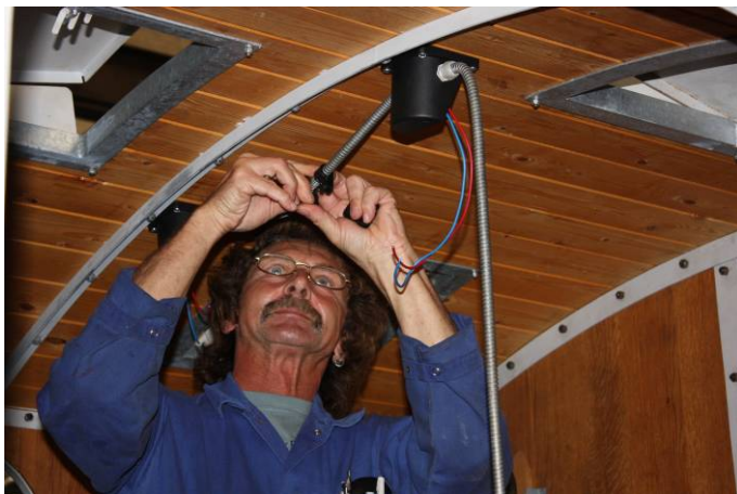
Leitungsverlegung für die Wasserstandslampen im Führerhaus.
