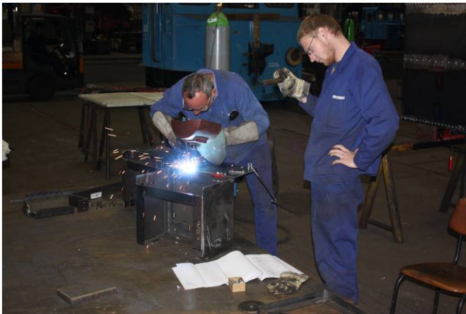
Die Schweißarbeiten am Batteriekasten kommen zum Abschluss.
