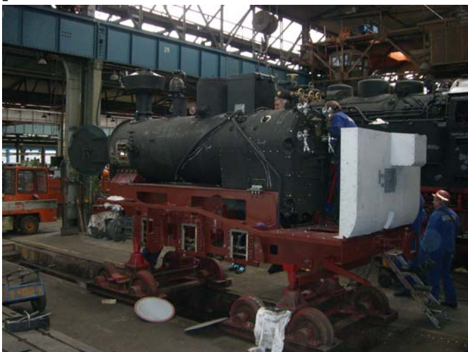
An den inneren Wasserkästen wird der Deckel vom Einstiegsloch angebaut.
