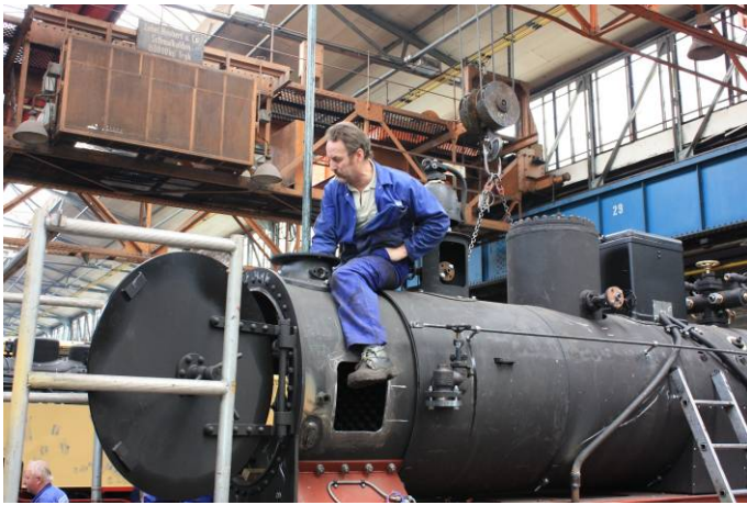
Für die Montage des Ausströmzweigrohres muss dieses genau eingelötet werden.
