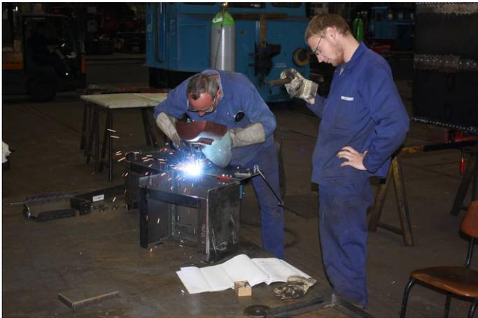
Die Schweißarbeiten am Batteriekasten kommen zum Abschluss.
