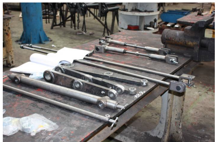
Die Komponenten der mechanischen Bremse werden für den Einbau vorbereitet.
