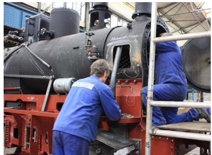
Das Einströmrohr auf der rechten Seite der Lok wird eingepasst.
