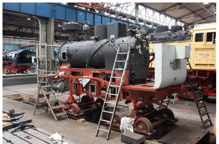
Ansicht der linken Lokseite, ebenfalls mit den angebauten Sandfallrohren.
