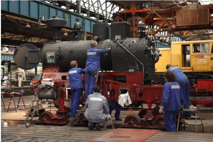
Die Sandfallrohre werden auf der linken Seite der Lok angepasst.
