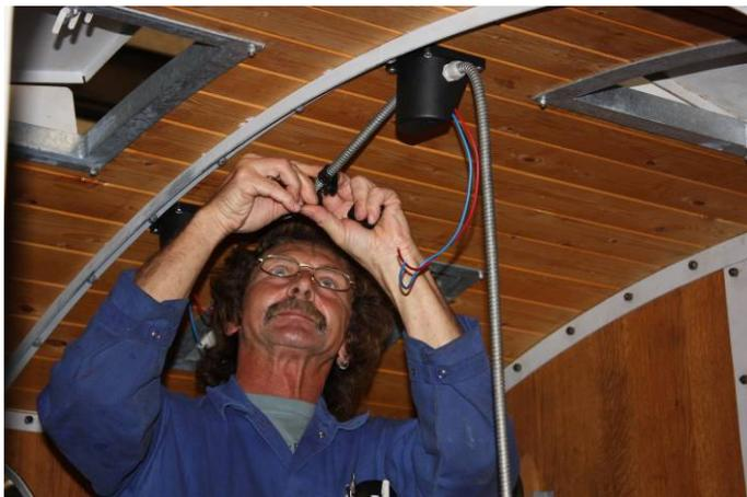
Leitungsverlegung für die Wasserstandslampen im Führerhaus.
