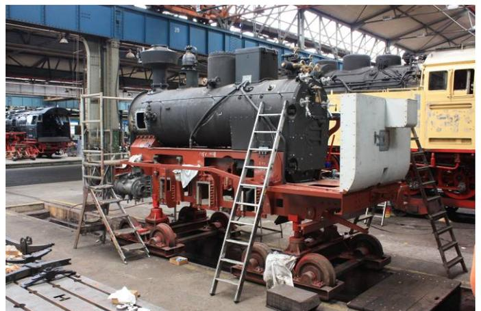
Ansicht der linken Lokseite, ebenfalls mit den angebauten Sandfallrohren.
