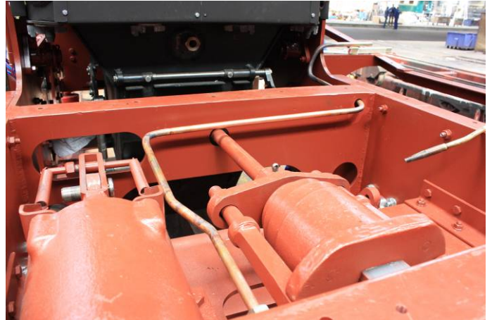
Unter dem Führerstandsfußboden wurde die Dampfbremse fertig eingebaut.
