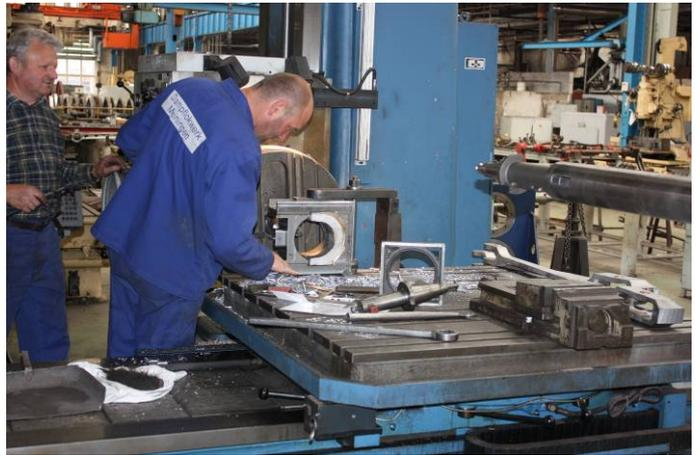
Nach dem Ausguss mit Weißmetall werden die Achslager auf Maß ausgedreht.
