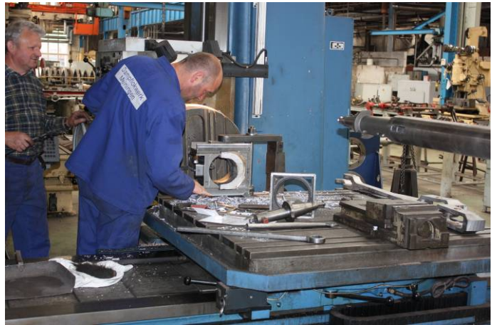
Nach dem Ausguss mit Weißmetall werden die Achslager auf Maß ausgedreht.
