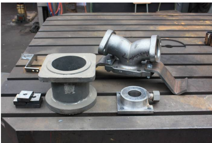
Das Ausströmzweigrohr ist an den Trägern befestigt, davor der Bläserring.
