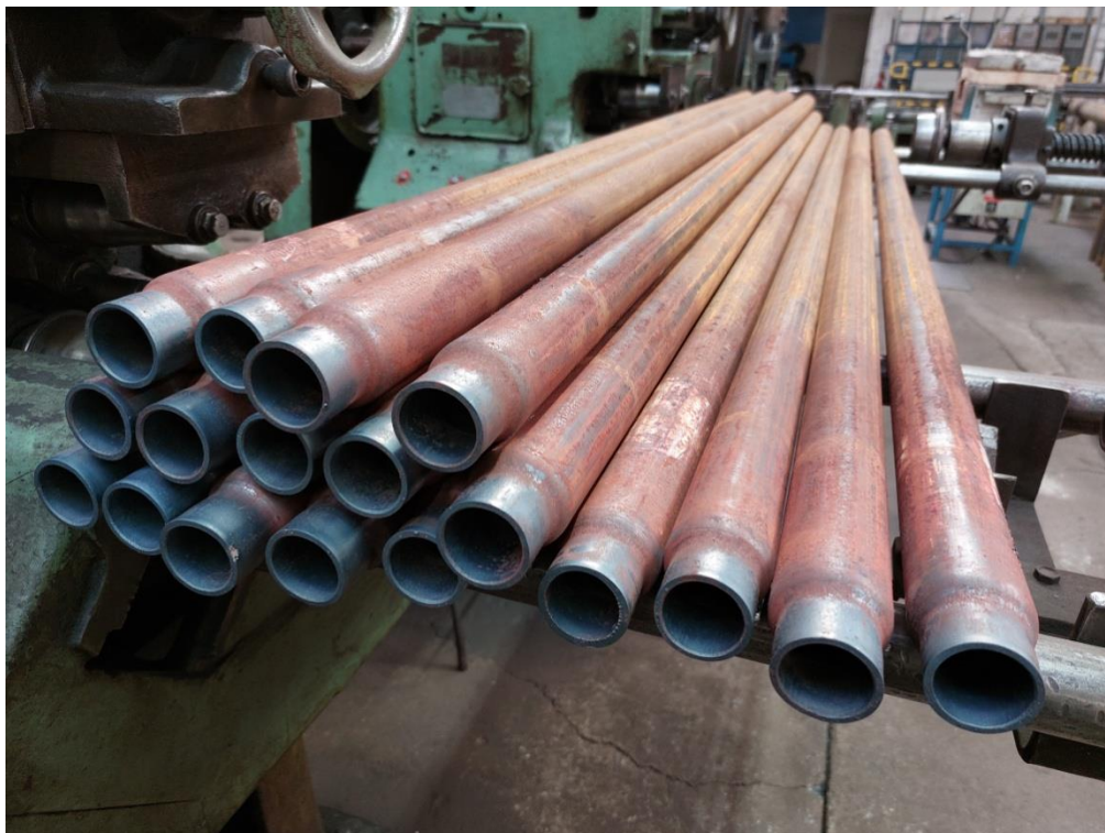
Bild 3: Vorbereitet für den Einbau – die Rohre für den Kessel am 06.07.2023. (Foto: Maximilian Roesler/DB-FZI Dampfloswerk Meiningen)
