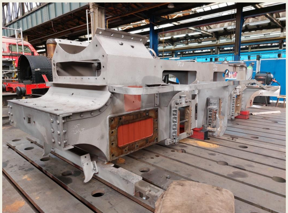
Bild 1: Arbeiten am Rahmen der I K Nr. 54 am 22.06.2023. (Foto: Maximilian Roesler/DB-FZI Dampfloswerk Meiningen)
