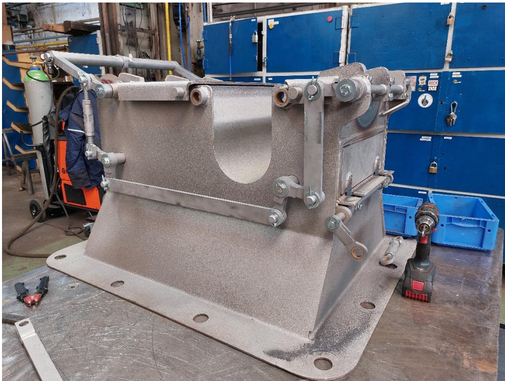
Bild 7: Der Aschkasten der I K in der Aufarbeitung am 07.07.2023. (Foto: Maximilian Roesler/DB-FZI Dampflokwerk Meiningen)
