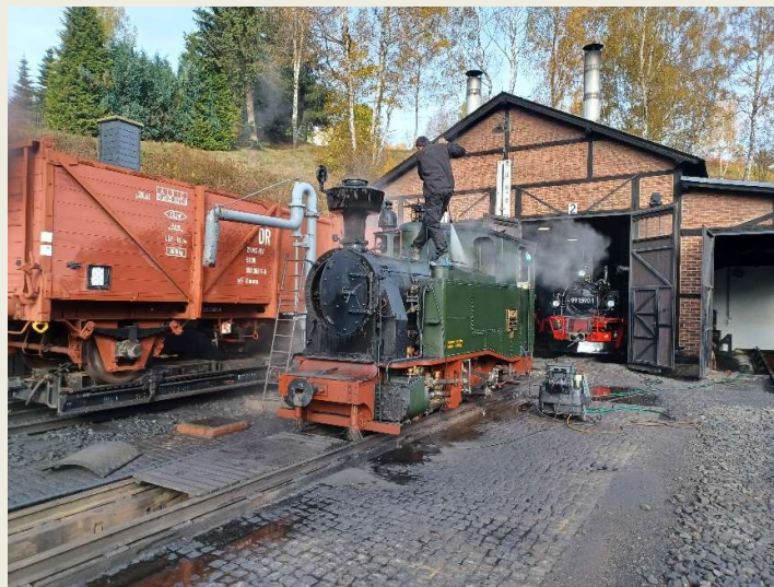
Bild 1: Die Vorbereitungsarbeiten für die Winterpause: das Auswaschen der I K Nr. 54 vor dem Heizhaus in Jöhstadt – hier eine Aufnahme aus dem Oktober 2024 (Foto: Helmut Siegel/IGP)
