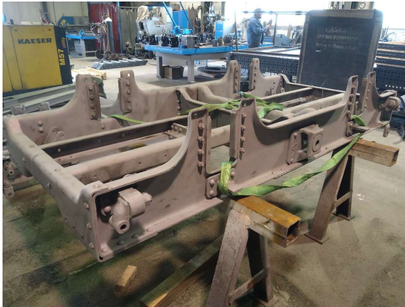
Bild 15: Die Drehgestelle des K 480 sind demontiert, sandgestrahlt und rissgeprüft. (Foto: IntEgro GmbH)
