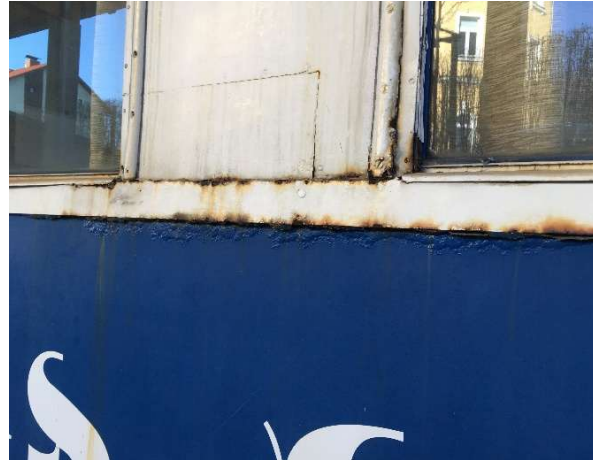
Bild 9 und 10: Schon äußerlich sichtbar: Der Zustand ist schlecht und das meiste wird noch von den Blechen der Außenhaut verdeckt. (Fotos: Stiftung SSB)
