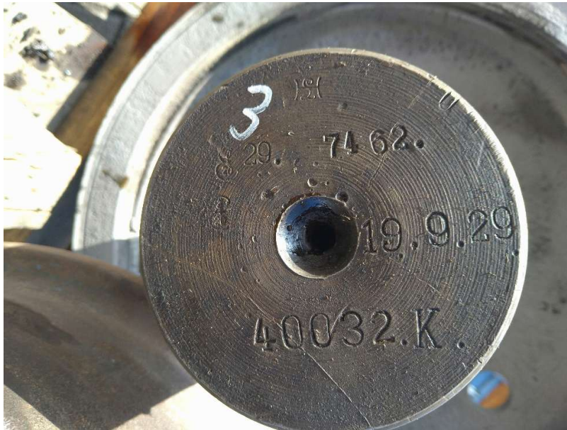
Bild 16: Die Achswellen sind ohne Befund, also weiter verwendbar – man beachte teilweise das Baujahr 1929. (Foto: IntEgro GmbH)
