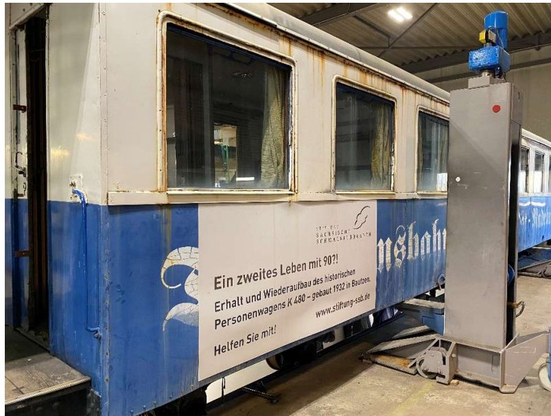
Bild 13: Nun endlich geht es los – der Wagen steht bereit zum Abheben des Wagenkastens von den Drehgestellen. (27.02.2026, Foto: Stiftung SSB)
